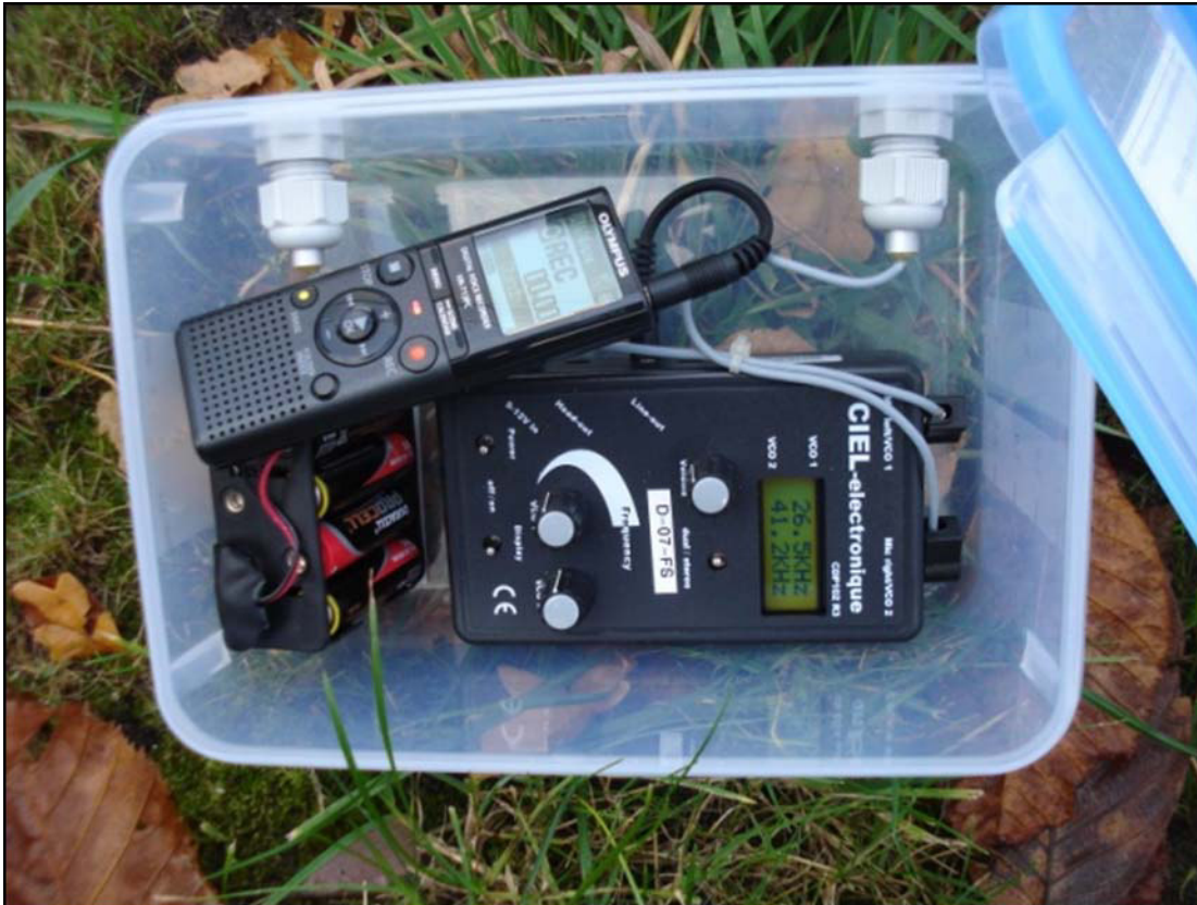
Abb. 1: Aufbau einer Horchkiste
